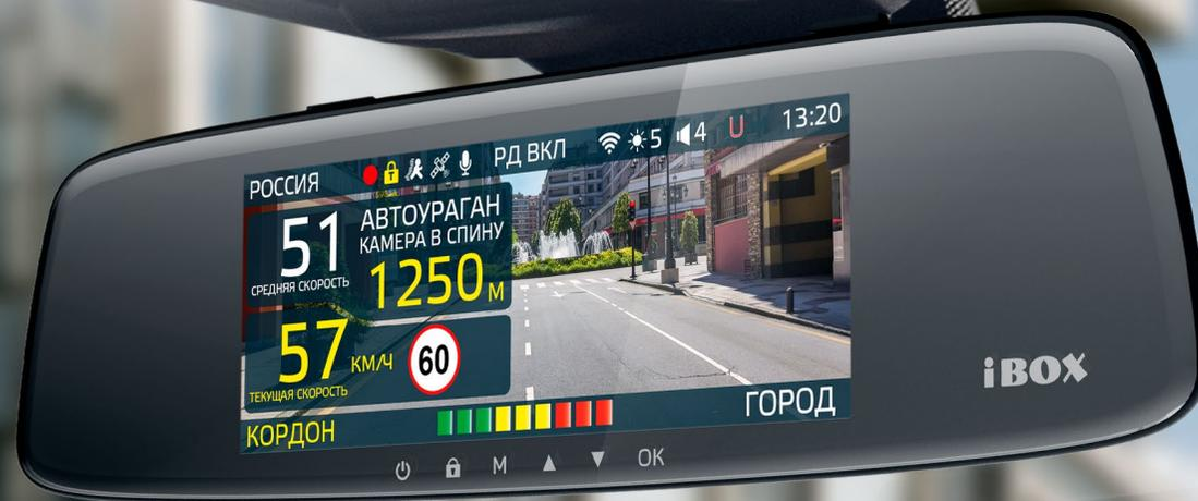
**Range LaserVision WiFi Signature Dual** разработан для установки в салоне автомобиля на зеркало заднего вида. Зеркальная поверхность устройства позволяет использовать его в качестве штатного зеркала. Таким образом, комбо-устройство не мешает обзору водителя и остается незаметным снаружи автомобиля.
